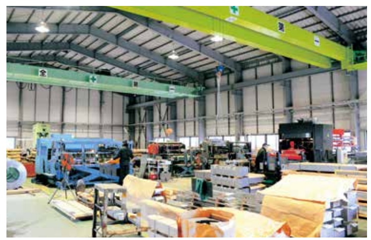
注文に応じて、鋼板の切断（シャーリング）加工を中心にプレス、穴あけ、溶接を行う本社工場。ここだけで月に300tの鉄を加工しています
