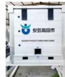
給水コンテナ(1,000ℓ) …2基
