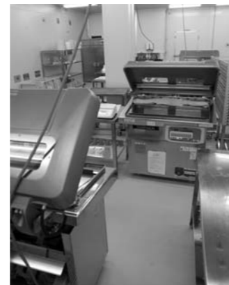
電気で加熱調理する機械。一気に熱を加えて、その後冷ますことで菌類を減らし鮮度を保たせる。
